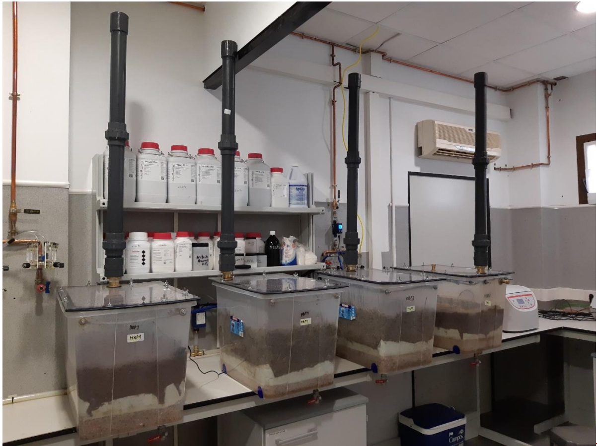
FOTO: Cuatro reactores con sus chimeneas de retención de gases en carbono activo.
